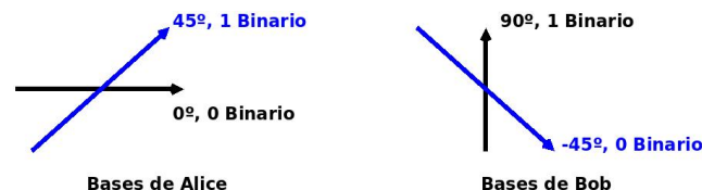
Figura 3: Polarización en B92 - Codificación de 2 estados
